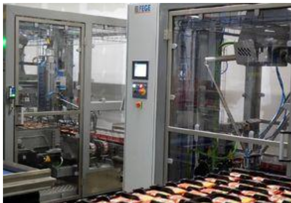
Les opérations pick-and-place sont réalisées par des robots delta.
